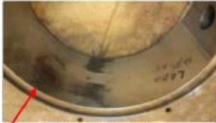
Fig. 2: Mancal LNA turbina, metade inferior
